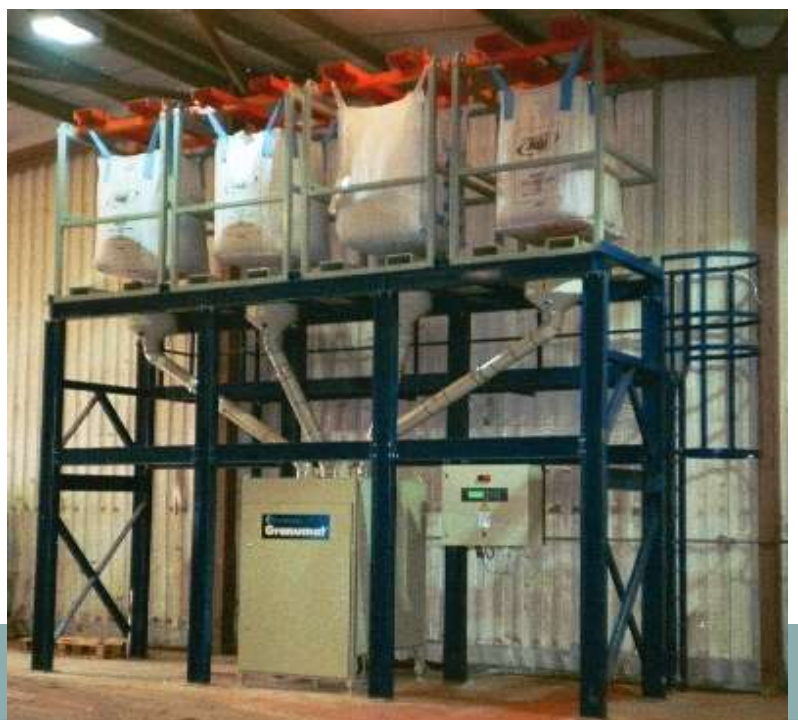
Aufbauvorschlag für 4 Farben, 2 Fließrohre Construction proposal for 4 colours, 2 fluidisation pipes
