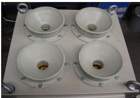
Ansicht Dosieröffnungen View of the dosing inlets
