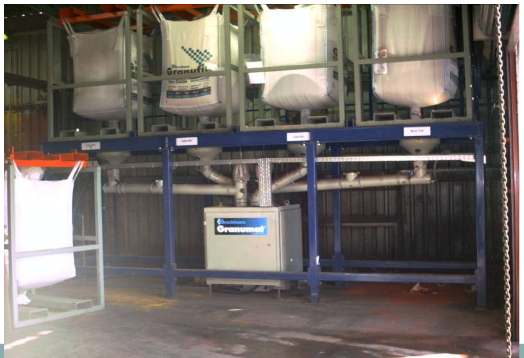
Aufbauvorschlag für 4 Farben, 2 Fließrohre Construction proposal for 4 colours, 2 fluidisation pipes
